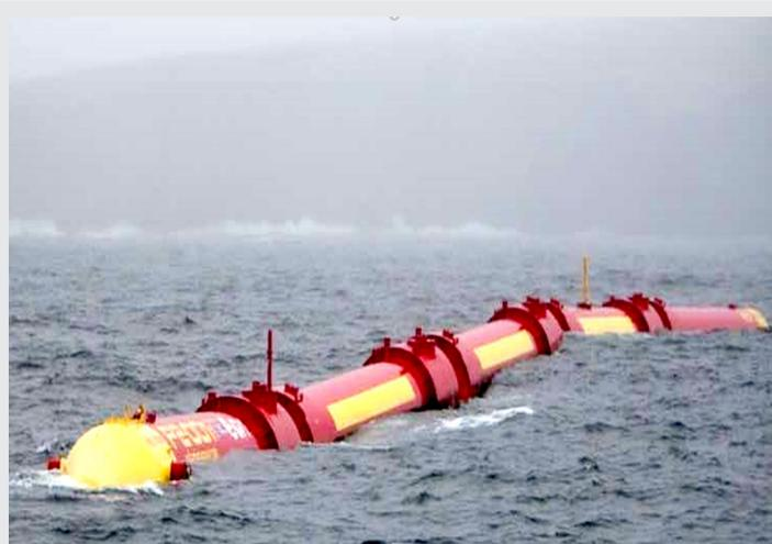
Figura 7. Generador eléctrico flotante Pelamis.
